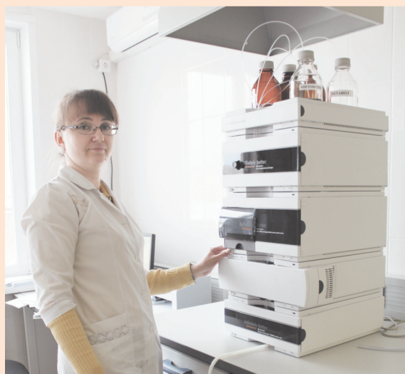
Высокоэффективный жидкостной хроматограф с диодноматричным детектором фирмы «Agilent». Безверхая И.М., старший инженер-химик 1 категории, первая освоила работу на этом приборе.
